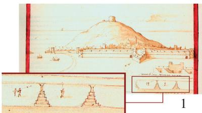
Figura 3. 1 Francisco de Holanda. Dibujo de la fortaleza de San Sebastián. Remarcada y ampliada, la planta de las cañoneras de redientes. 2. Cañonera de redientes de la fortaleza de Fuenterrabía
